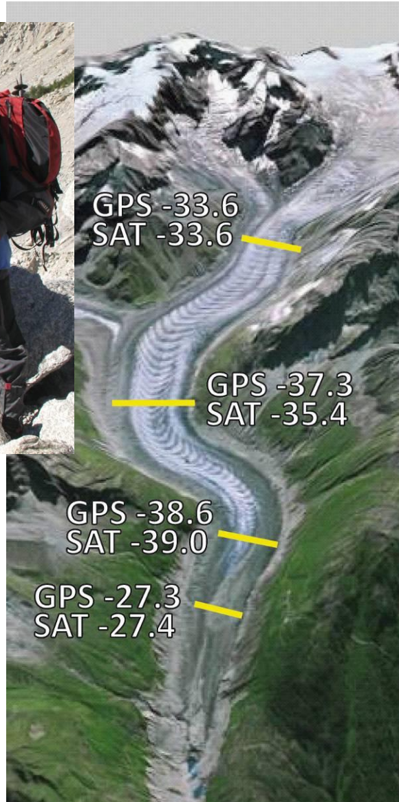
Comparaison des changements d'altitude (m) entre 2003 et 2012 déduits du différentiel de MNT et des profils GPS (données LGGE, Glacioclim). \mu = 0.3 \text{ m} ; \sigma = 1.3 ; N = 8
